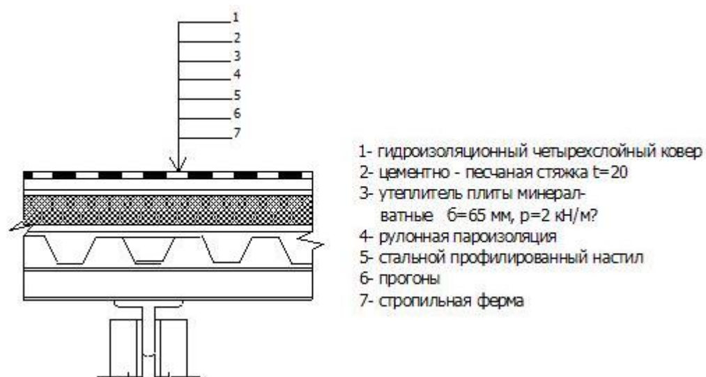
Рис. 2 Конструкция покрытия
